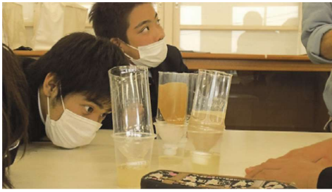
簡易浄化実験の比較。コーヒーフィルター過、砂ろ過、沈殿。
